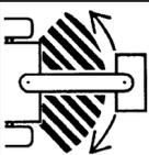
Não transite em rodovias ou estradas pavimentadas. Nas curvas fechadas, evite que as rodas do trator toquem o cabeçalho.
